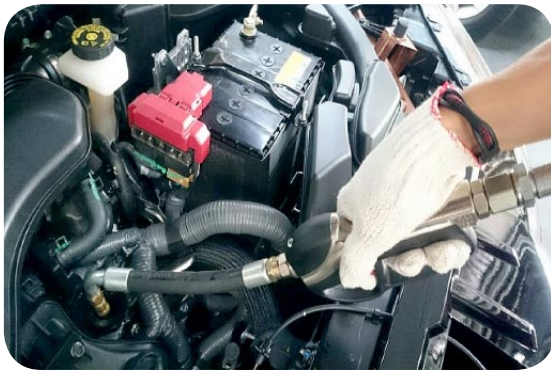
機油油槍設施
