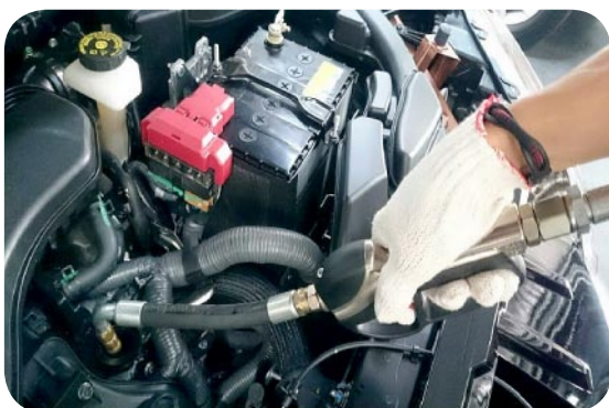
機油油槍設施
