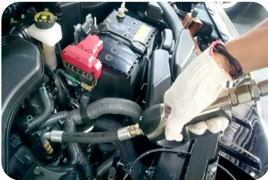
機油油槍設施
