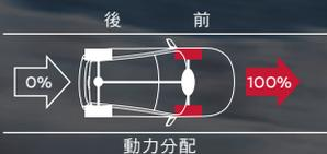
AWD當達到巡航車速穩定後，系統會自動將引擎動力全部導引至前面2輪，有效減少動力的傳輸耗損，獲取最高效率、最低油耗。
