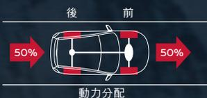
AWD會在靜止起步時，將引擎動力同時傳送至前、後4輪，增加起步時的瞬間抓地力，好提供車輛穩穩向前奔馳的起動力。
