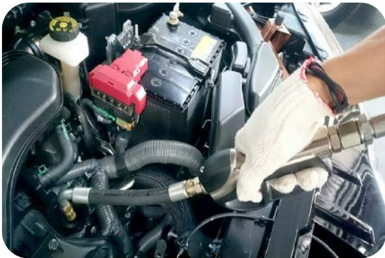
機油油槍設施
