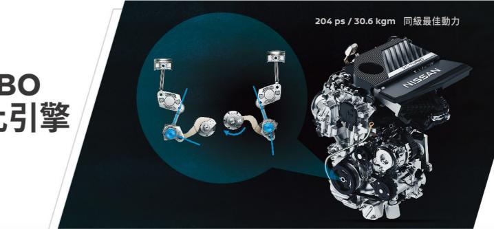
可聰明調整連桿角度，自動轉換壓縮比(8:1~14:1)能夠同時實現動力性能及達到省油優勢，賦予您順暢加速的駕馭樂趣。
